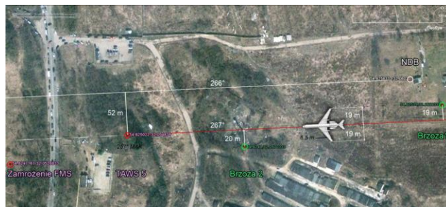
Rys. 3. Trajektorija pozioma w ostatnich sekundach lotu oparta na odczytach Universal Avionics.
